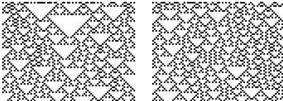
ACE 18, deux états initiaux aléatoires ( t = \downarrow ) Exemple d'automate non équicontinu : les configurations initiales sont identiques à 90%.
